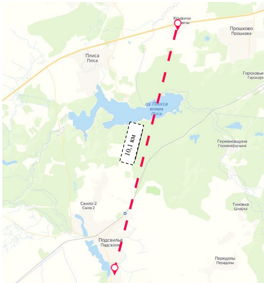
Рисунок 8 – Схема радиорелейного пролета
